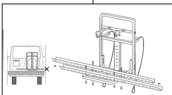
**D** HINWEIS - Die Schienen können in einer beliebigen Position zur Zentrierung der Fahrräder am Fahrzeug befestigt werden
