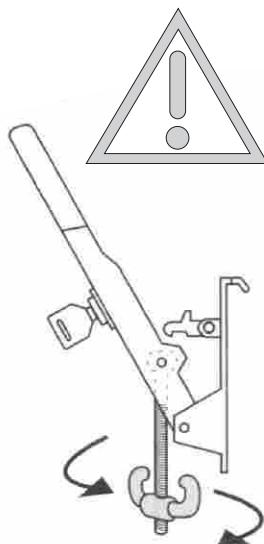
**E AGGIUSTAMENTO MILLIMETRICO:** Se la leva rapida non si chiude perché i cavi di acciaio sono troppo tesi, regolatevi svitando l'ancorella. Al contrario se la leva rapida si chiude ma i cavi di acciaio sono allentati, regolatevi avvitando l'ancorella.
