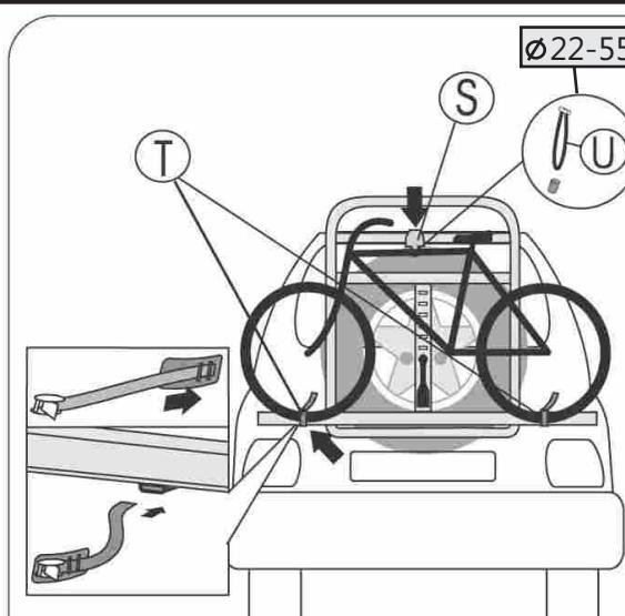
**I** Ricordarsi di bloccare le biciclette, in 3 punti diversi, mediante le ganasce (S) ed i cinturini (T). Poichè esistono diversi tipi di telai, sono disponibili cavi più lunghi per le ganasce (U), per poter bloccare qualsiasi tipo di bicicletta (Vedi OPTIONAL).
