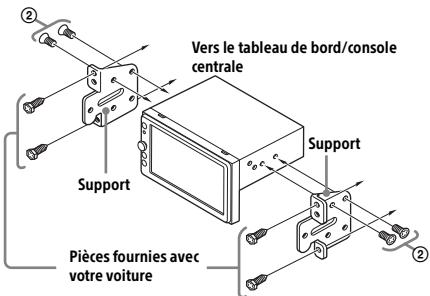
Quand vous montez cet appareil sur les supports préinstallés de votre voiture, utilisez les vis fournies ② dans les orifices appropriés de la voiture : T pour TOYOTA et N pour NISSAN.
