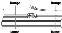
Après avoir fait correspondre correctement les connexions et les câbles d'alimentation commutée, connectez l'appareil à l'alimentation du véhicule. Si vous avez des questions et des problèmes de connexion de cet appareil, qui ne sont pas abordés dans ce mode d'emploi, contactez votre concessionnaire automobile.
