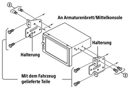
Wenn Sie dieses Gerät an den eingebauten Halterungen des Fahrzeugs montieren, befestigen Sie es mit den mitgelieferten Schrauben ② in den für den jeweiligen Fahrzeugtyp geeigneten Schraubenbohrungen:
