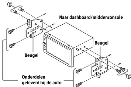
Bij het monteren van dit apparaat op de voorgeïnstalleerde beugels van uw auto, brengt u de bijgeleverde schroeven ② aan in de schroefopeningen die geschikt zijn voor uw auto: T voor TOYOTA en N voor NISSAN.
