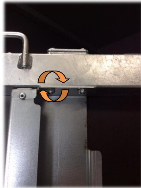
6) Votre support de roue de secours est fixé. Placer ensuite la roue de secours, les rondelles puis les écrous nylstop M12 afin de verrouiller la roue de secours sur son support.
