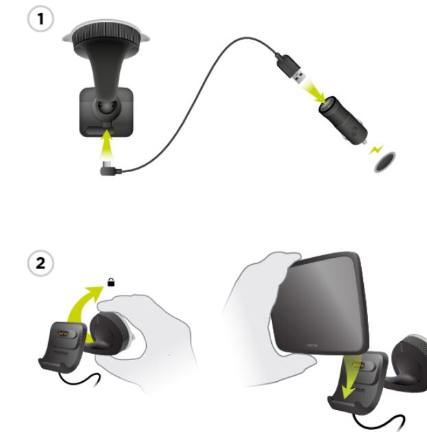
① Sluit de meegeleverde USB-kabel aan op de houder en de USB-auto-oplader. Steek de stekker van de oplader in de voedingsbron op je dashboard..
