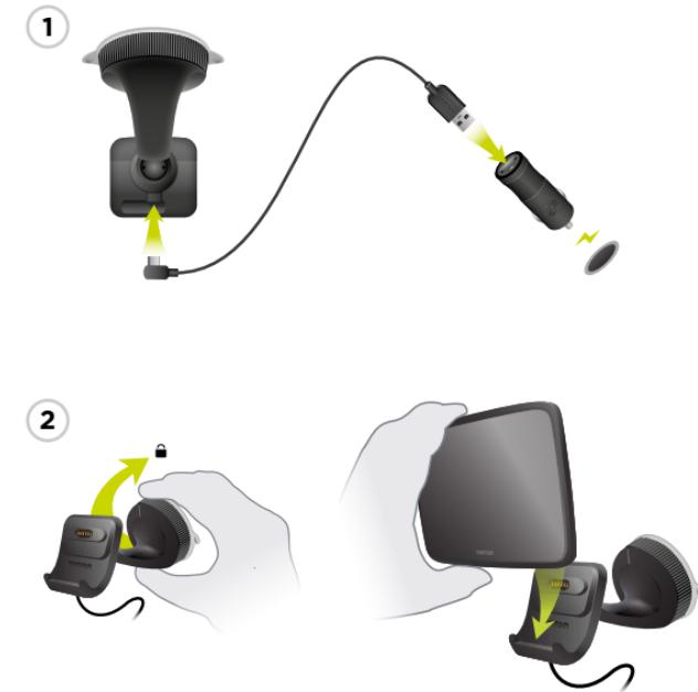
① Connectez l'une des extrémités du câble USB fourni à la fixation, et l'autre extrémité au chargeur de voiture USB. Branchez le chargeur à l'allume-cigare de votre tableau de bord.
