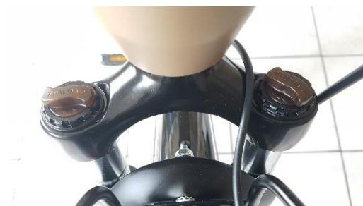
La forcella è dotata di una regolazione di precompressione, ruotare le ghiere in senso orario per irrigidire leggermente la sospensione.
