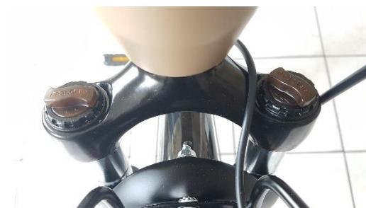
Ihre Gabel ist mit einer Vorrichtung zur Einstellung der Vorspannung ausgestattet, drehen Sie die Einstellräder im Uhrzeigersinn, um Ihre Federung etwas härter einzustellen..
