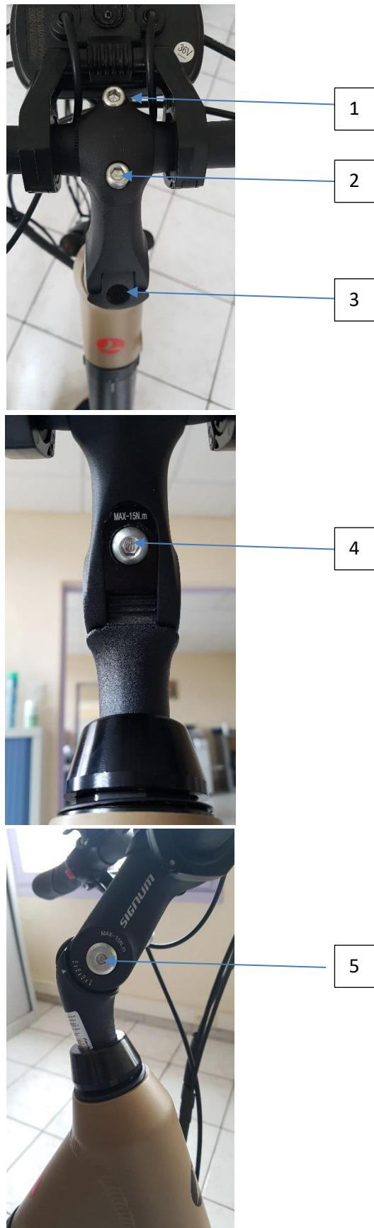
**1: Aandraaien van de stuuroog op de stuurpen**
