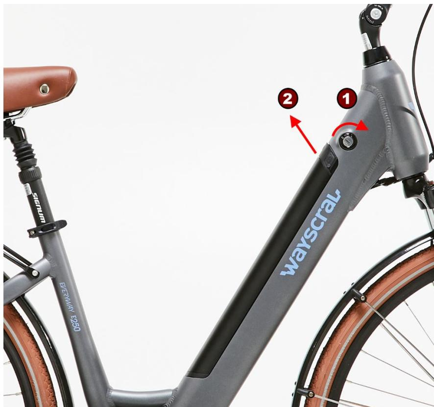
Um den Akku wieder einzusetzen, setzen Sie ihn von unten beginnend ein und drehen Sie dann die Oberseite, bis sie einrastet.
