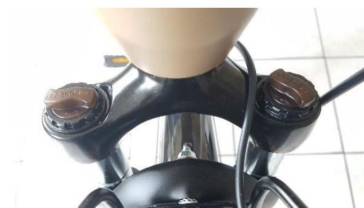
Widelec jest wyposażony w regulację naprężenia wstępne – należy obrócić pokrętła w kierunku zgodnym z ruchem wskazówek zegara, aby lekko dokręcić zawieszenie.
