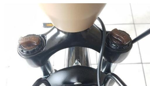
A sua forqueta está equipada com um ajuste de pré-carga, vire as molas no sentido dos ponteiros do relógio para tornar a sua suspensão ligeiramente mais dura.
