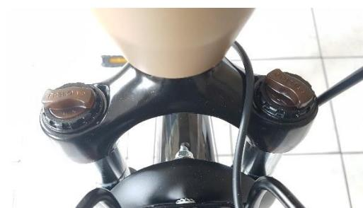
La horquilla está equipada con un ajuste de pretensado, gire las ruedas en el sentido de las manecillas del reloj para volver más dura la suspensión.
