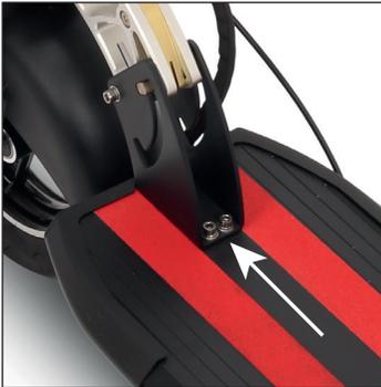
Une fois les caches en plastique retirés, dévisser les vis de fixation de la potence de direction.
