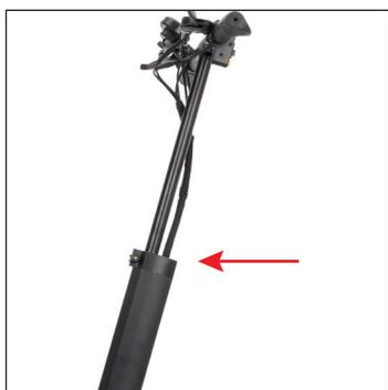
Une fois le guidon verrouillé, vous pouvez régler la hauteur de celui-ci grâce au loquet se trouvant comme indiqué sur la photo.
