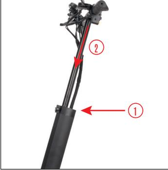
Pour plier votre trottinette et la transporter, déverrouiller le loquet de serrage du tube de guidon. Faire descendre le tube dans sa position la plus basse. Puis replier les poignées en tirant de chaque côté le système de pliage comme indiqué sur la photo.
