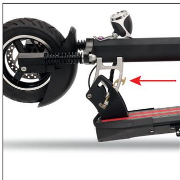
Appuyer sur le bouton presseur afin de déverrouiller la sécurité de pliage.
