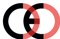
Faux marquage CE (trop proche)
