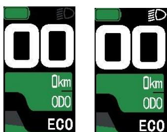
Uw display heeft ook achtergrondverlichting. De helderheid van het scherm kan worden aangepast door de knop "i" 2 seconden ingedrukt te houden.
