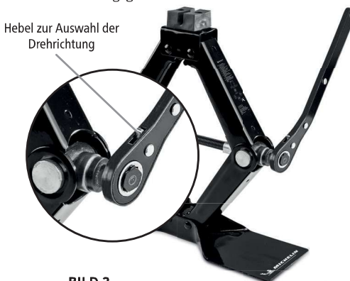
BILD 2 Wagenheber in der unteren Position, mit Kurbel
