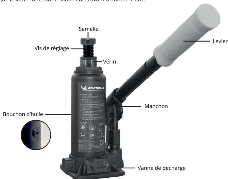
Figure 1 Nomenclature des éléments d'un Cric Hydraulique Bouteille
