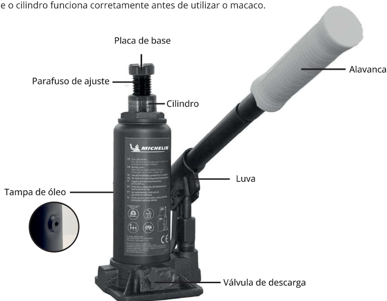
Figura 1 Nomenclatura dos elementos de um Macaco Hidráulico Garrafa
