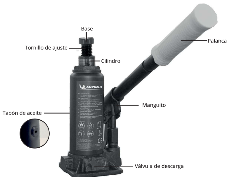
Figura 1 Lista de piezas de un gato hidráulico de botella
