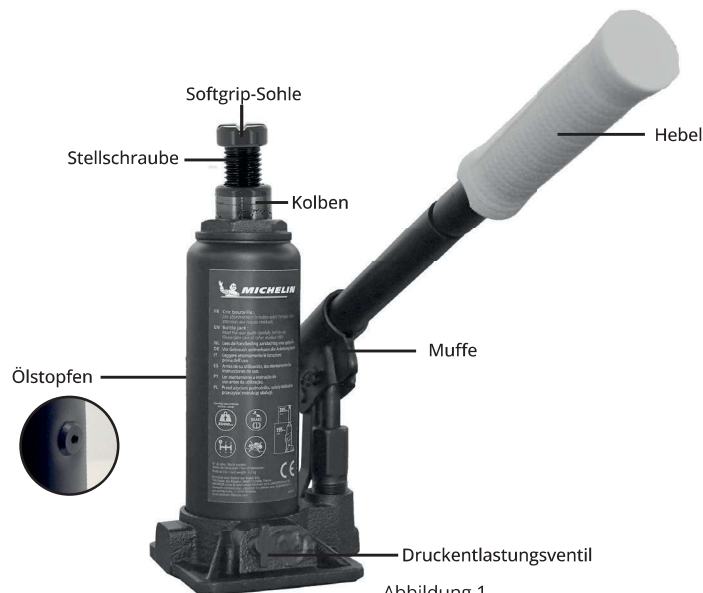
Abbildung 1 Nomenklatur der Teile eines hydraulischen Stempelwagenhebers
