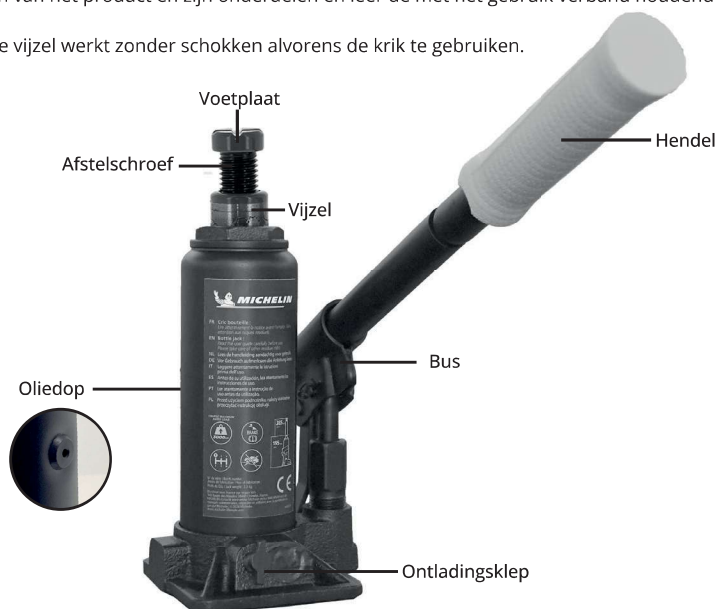
Figuur 1 Stuklijst van de onderdelen van een Hydraulische Fleskrik
