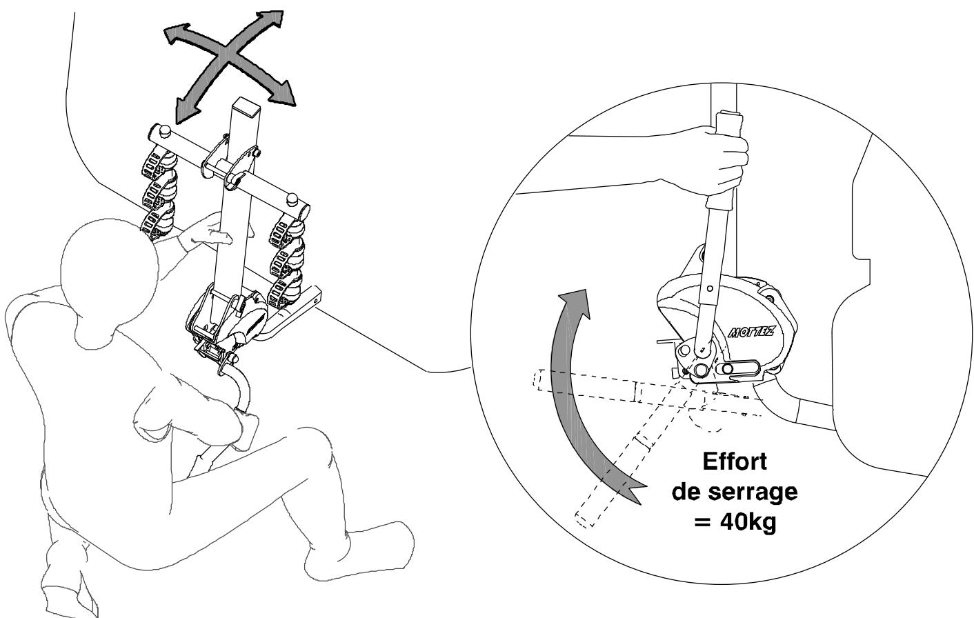
Maintenez le porte vélo en position vertical, puis, actionnez la poignée comme montrée ci-dessus à droite. Une certaine résistance doit être ressentie pour un serrage optimal. Pour ce faire, il est nécessaire de régler le porte vélo en agissant sur la vis de pression. L'effort de serrage doit être égal à 40kg.
