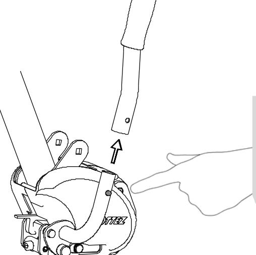
Pour remettre le produit en place, lever le mat jusqu'à ce qu'il retrouve sa position verticale, puis **remettre la vis et serrer la molette (effort de serrage 8 N.m)**
