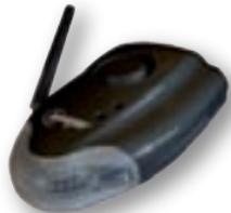
Centrale bi-directionnelle (émission & réception) avec sirène, flash lumineux, capteur de chocs, capteur infrasonique (pression d'air) intégrés. Alimentation par 1 batterie Li-Ion 4,8 V. rechargeable
