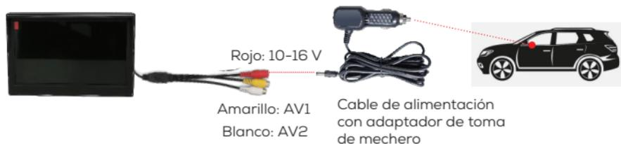
2. Gracias a la ventosa con gel adhesivo, el monitor se puede instalar tanto en el salpicadero como en el parabrisas del coche según su preferencia. Fije el monitor dentro del vehículo y ajuste su ángulo, asegurándose de que pueda ver fácilmente la pantalla sin que bloquee su visión periférica. Debe conectar el cable RCA de la cámara trasera al cable RCA del monitor.
