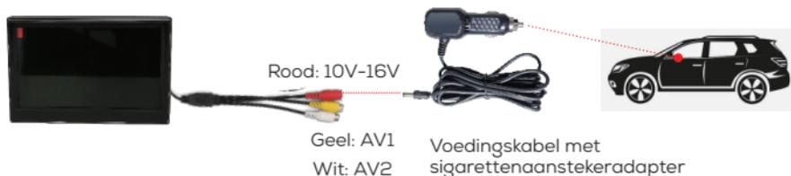
2. Met de zuignap met kleefgel kan de monitor naar wens op het dashboard of op de voorruit van de auto worden bevestigd. Bevestig de monitor in uw voertuig en pas de hoek aan zodat u de monitor gemakkelijk kunt zien zonder dat deze uw zicht op de omgeving belemmert. De RCA-kabel van de achteruitrijcamera moet worden aangesloten op de RCA-kabel van de monitor.
