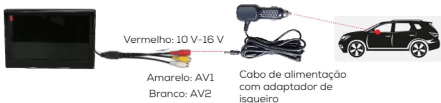
2. Graças à ventosa com gel pegajoso, o monitor pode ser instalado no tablier ou no pára-brisas do carro de acordo com as suas preferências. Fixe o monitor no interior do seu veículo e ajuste o seu ângulo, assegurando-se de que pode ver facilmente o seu ecrã enquanto não obstrui a sua visão do ambiente. É necessário ligar o cabo RCA da câmara traseira ao cabo RCA do monitor.
