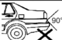
Asegúrese de que no haya partes del vehículo en el rango de detección de los sensores para evitar detecciones falsas.
