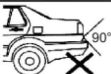
Vergewissern Sie sich, dass keine anderen Teile des Fahrzeugs im Erfassungsbereich der Sensoren befinden, um eine Fehlerkennung zu vermeiden.
