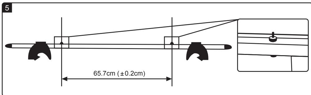
Mise en place du porte ski - Aanbrenging van de skidrager
