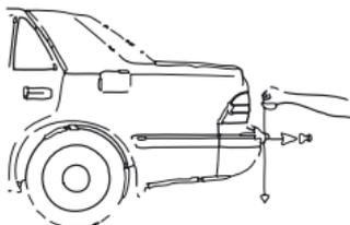
L'axe de vision de la caméra doit être parallèle au sol.
