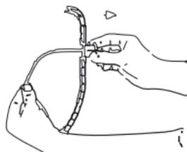
Placez la caméra dans le trou de perçage grâce aux clips métallique
