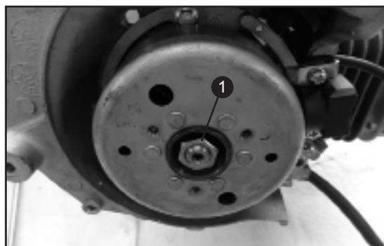
3. Retirez le volant d'inertie (2) à l'aide d'un extracteur M27P1L (3).
