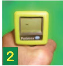
2. Un clic et l'arrêt du signal sonore indiquent la fin de la prise de mesure. Une barre clignotante défile durant l'analyse.
