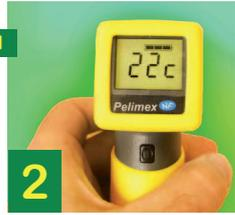
2. L'appareil émet un bip. Il affiche la température du capteur et le niveau des piles durant l'initialisation.
