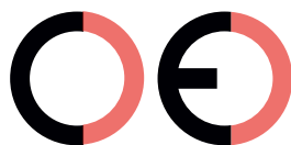
Faux marquage CE (trop éloigné)
