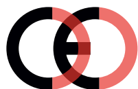
Faux marquage CE (trop proche)
