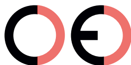
Faux marquage CE (trop éloigné)
