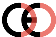
Faux marquage CE (trop proche)
