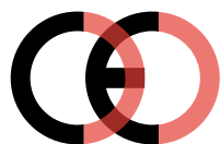
Faux marquage CE (trop proche)
