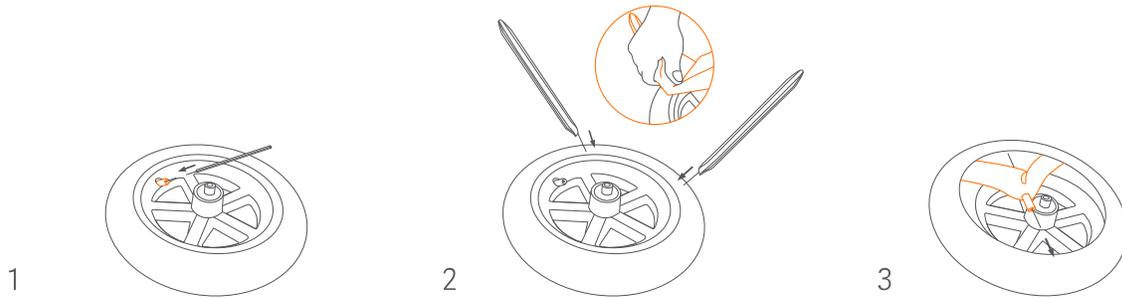
1. Dégonflez la chambre à air en premier. À l'aide d'un outil, appuyez sur la tige centrale dans la soupape à air pour évacuer l'air de la chambre à air et pincez énergiquement le pneu avec l'autre main à différents endroits pour évacuer plus d'air.
