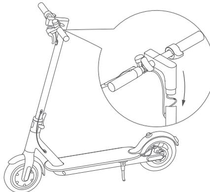
3. Serrez les vis des deux côtés de la potence avec la clé à six pans.
