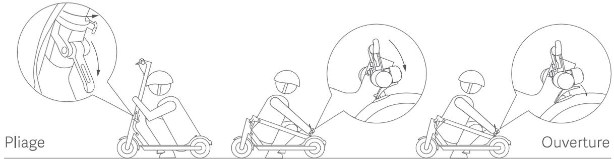
Assurez-vous que le scooter est bien éteint. Pour plier la trottinette/le scooter, déverrouillez le mécanisme de pliage et rabattez la potence du guidon pour l'accrocher au système d'attache sur le garde-boue arrière. Pour l'ouvrir, appuyez sur le déclencheur de la sonnette afin de retirer le système d'attache, relevez le guidon et verrouillez la structure pliante.
