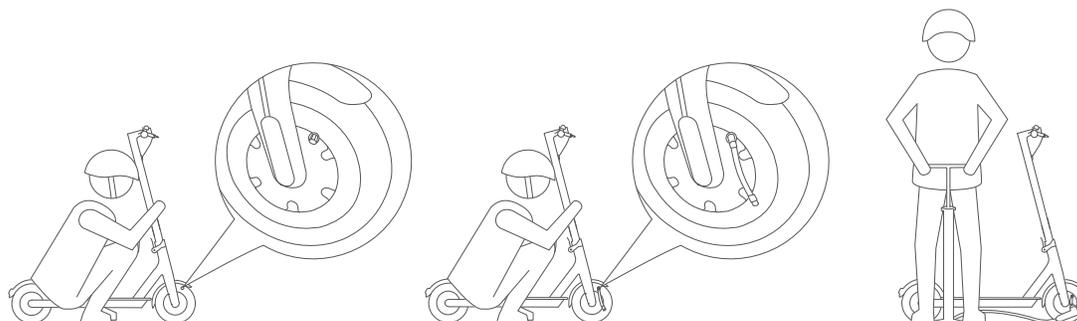
Si vos pneus sont à plat, retirez le capuchon à visser de la soupape et placez l'embout prolongé dans la soupape pour les gonfler.
