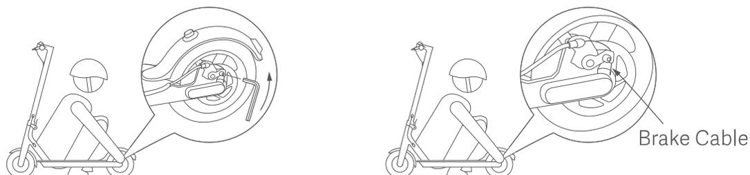
Si le frein est trop serré, utilisez la clé à six pans M4 pour desserrer les vis de l'étrier et repoussez légèrement le câble de frein pour réduire la longueur exposée, puis serrez les vis. Si le frein est trop lâche, desserrez les vis et tirez légèrement le câble de frein pour allonger la longueur exposée, puis serrez les vis.
