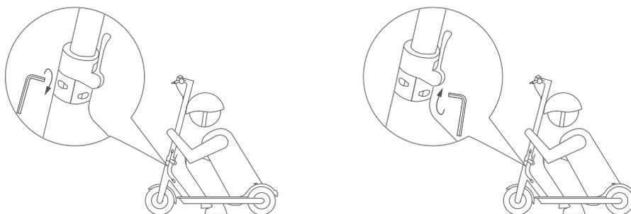
S'il y a du jeu au niveau du guidon et de la potence lorsque vous conduisez le scooter, utilisez la clé à six pans M5 pour serrer les vis du mécanisme de pliage.
