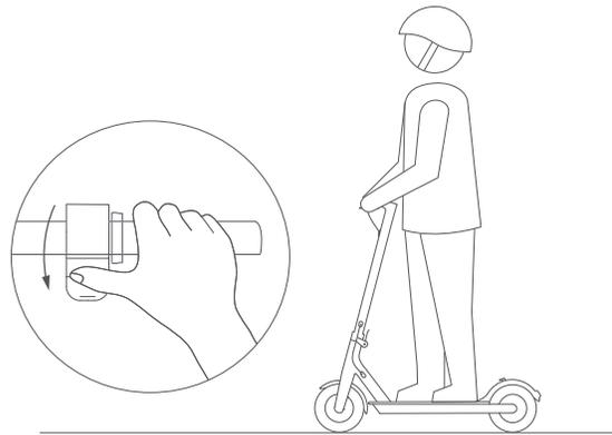
3. Lorsque le scooter commence à avancer en roue libre, placez les deux pieds sur le repose-pied et appuyez sur l'accélérateur (l'accélérateur se déclenche une fois que la vitesse en roue libre dépasse 5 km/h).
