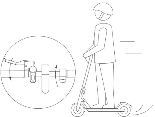
4. Relâchez l'accélérateur pour que le système de récupération d'énergie cinétique (KERS) s'enclenche automatiquement et freine doucement. Actionnez le levier de frein pour un freinage rapide.
