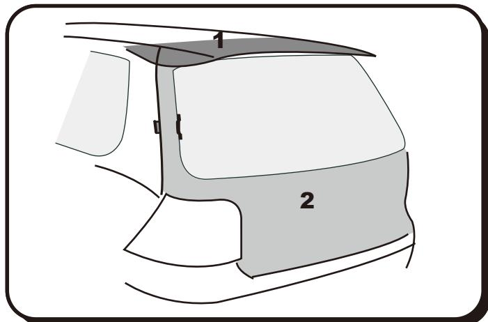
**ATTENTION, CE PORTE-VÉLOS EST COMPATIBLE UNIQUEMENT AVEC LES VÉHICULES PRÉSENTS SUR LA LISTE D'AFFECTATION ET MUNIS D'UN BÉQUET ET HAYON MÉTAL. UTILISER L'AIMANT FOURNI POUR CONTRÔLER QUE LES PARTIES 1 ET 2 SONT BIEN EN MÉTAL. SI L'AIMANT NE COLLE PAS SUR UNE DES PARTIES, NE PAS MONTER LE PORTE-VÉLOS SUR LE VÉHICULE.**
