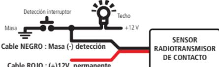
Instalación combinada con el sensor de contacto para capó: El sensor de contacto para capó transmite una señal por la masa en cuanto se abre el capó (cierre del contacto).
