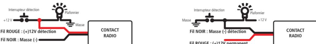
Installation en complément du contact capot : Le contact capot transmet une masse dès que le capot est ouvert (fermeture du contact).
