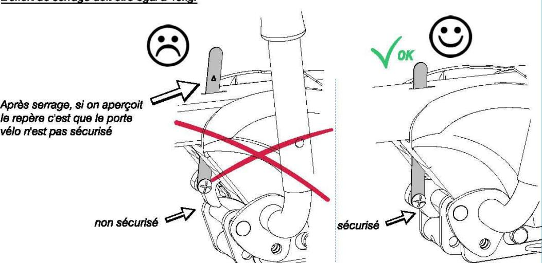
Serrer la vis de réglage manuellement, dans certains cas, le réglage peut être plus dur, le cas échéant utiliser une clé mâle 6
