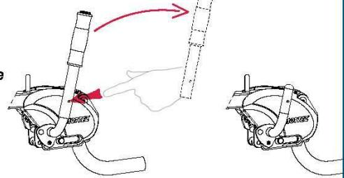
Pour remettre le produit en place, il suffit de basculer l'ensemble jusqu'à sa position initiale
