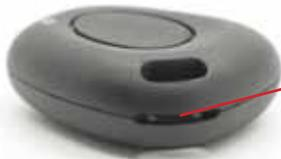
DÉCLIPSEZ LA COQUE DE VOTRE CLÉ D'ORIGINE À L'AIDE D'UN TOURNEVIS PLAT APRÈS AVOIR RETIRÉ LA VIS.
