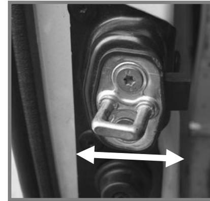
**F/** Si l'étrier de l'échelle heurte la portière lors de sa fermeture, il est possible de régler la position du verrou de la portière (Photo ci-dessus) afin de lui donner plus de jeu.
