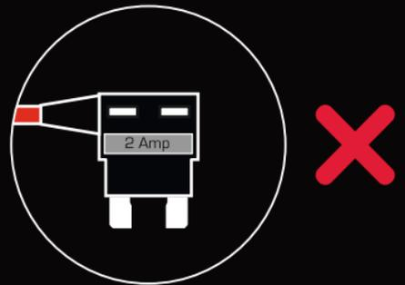
**REMARQUE:** Le fusible de 2 A fourni DOIT être placé dans la prise supérieure, comme illustré ci-dessus, en ligne avec le câble rouge. Le fusible d'origine doit être remplacé dans la prise inférieure. Le non-respect de cette consigne modifiera la protection du circuit d'origine à l'intérieur du véhicule. Bien que cela ne causera AUCUN dommage au véhicule, cela pourrait faire sauter le fusible inférieur de 2Amp.
