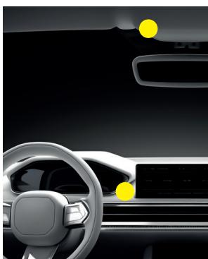
Identifique la posición en el habitáculo para la instalación del micrófono (7) para que esté lo más cerca posible y orientado hacia el conductor para optimizar sus prestaciones.
