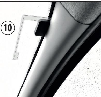
Instalar a antena DAB+ na parte direita do para-brisa e certificar-se de que a parte cor bronze esteja em contacto com a carroceria do veículo (fundamental para a alimentação da antena).
