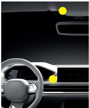
Individuare la posizione nell'abitacolo per l'installazione del microfono (7) in modo che sia più vicino possibile e rivolto verso il conducente per ottimizzarne le prestazioni.
