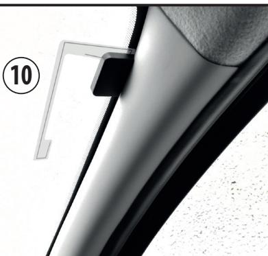
Installare l'antenna DAB+ sulla parte destra del parabrezza con la parte color bronzo a contatto con la carrozzeria del veicolo (fondamentale per l'alimentazione dell'antenna).
