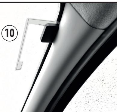
Instale la antena DAB+ en la parte derecha del parabrisas con la parte de color bronce en contacto con la carrocería del vehículo (fundamental para la alimentación de la antena).
