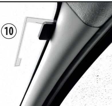
Bringen Sie die DAB+-Antenne auf der rechten Seite der Windschutzscheibe an, so dass der bronzefarbene Teil mit der Karosserie in Berührung kommt (wichtig für die Antennenzuführung).
