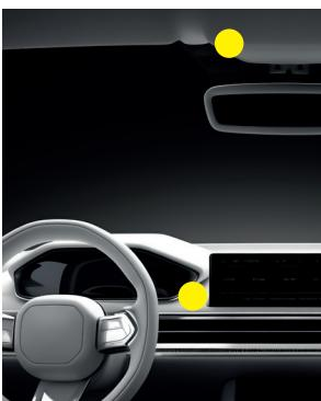
Choisir l'emplacement dans l'habitacle pour installer le microphone (7) de manière à ce qu'il soit le plus proche possible et face au conducteur pour une utilisation optimale.
