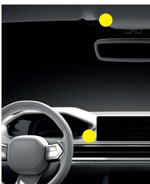
Suchen Sie die Position im Fahrzeuginnenraum für den Einbau des Mikrofons (7) so aus, dass es so nah wie möglich und zum Fahrer hin ausgerichtet ist, um seine Leistung zu optimieren.
