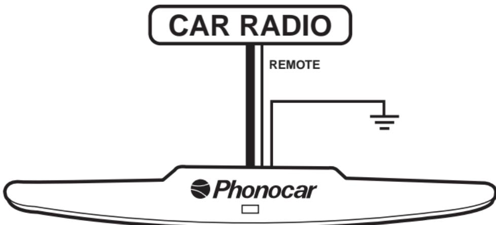
I - Rendere perfettamente pulita ed asciutta la zona dove si vuole applicare l'antenna. Togliere il supporto di protezione dall'adesivo. Stabilire la posizione sul parabrezza e procedere ad applicare l'antenna inserendola vicino alla guarnizione.
