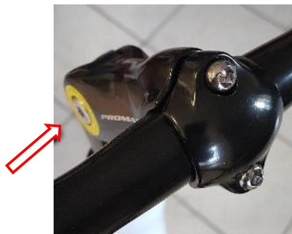
Generalmente, después es necesario ajustar la posición de la cimbra en la potencia aflojando los tornillos de la tapa de potencia, girando la cimbra según convenga y volviendo a ajustar los mismos tornillos. Asegúrese de que la cimbra está bien centrada.
