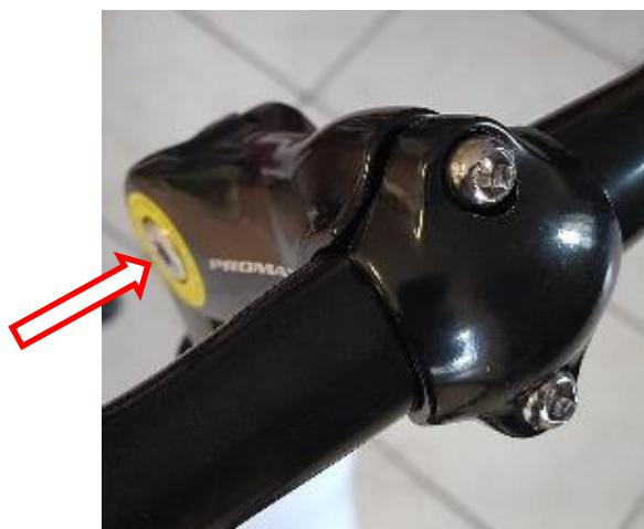
Il est souvent nécessaire ensuite d'ajuster la position du cintre sur la potence en desserrant les vis du capot de la potence, tournez le cintre à votre convenance et resserrez ces mêmes vis. Prenez garde à ce que le cintre soit correctement centré.
