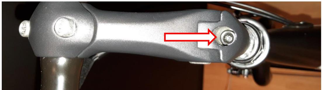
Veillez à ne pas dépasser le repère minimum d'insertion. Ce repère d'insertion ne doit jamais être visible lors de l'utilisation du vélo.
