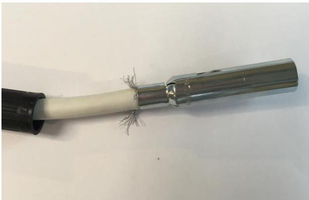
Faire glisser le corps métallique. Il doit passer au dessus de la gaine et de la tresse de masse sur 5 mm environ.
