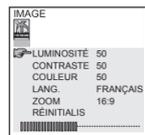
Utilisez les touches ▲/▼ pour sélectionner les paramètres « Luminosité », « Contraste » ou « Couleur » puis utilisez les touches ◀/▶ pour effectuer les réglages correspondants. Sélectionnez « Lang. » . Utilisez les touches ◀/▶ pour modifier la langue du menu.
