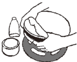
Rys. A : Nałożyć czysty krążek do polerowania.
