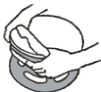
Figura G: Scoateți cu grijă bucata de bumbac din aparatul polish pentru curățare.
