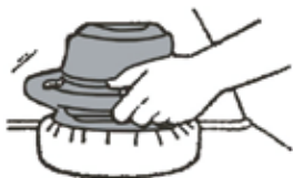
Figura C: Accendere e spegnere sempre la lucidatrice quando è ancora collocata sulla carrozzeria.
