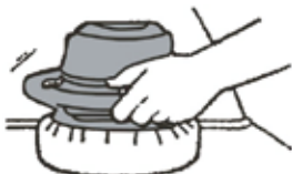
Figura C: Deverá sempre ligar e desligar a polidora antes de a remover, ou seja, enquanto em contacto com a carroçaria.
