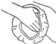
Figure F: Pour un polissage optimale, n'hésitez pas à finir à la main dans les parties les moins accessibles.
