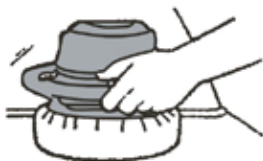
Рисунок С: Включайте и выключайте полировальную машинку, когда она еще находится на кузовной поверхности.
