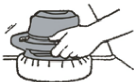
Imagen C: Encienda y apague la pulidora siempre cuando ésta esté sobre la carrocería del vehículo.
