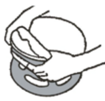
Рисунок G: Аккуратно снимите колпак с полировальной машины и вычистите его.
