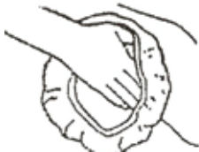
Рисунок F: Для оптимального качества полировки обрабатывайте труднодоступные места вручную.
