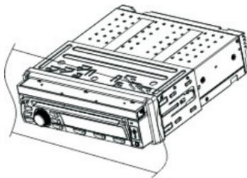
2 Introduisez les clés dans l'ouverture entre l'appareil et le collier.
