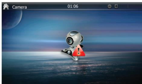
Menu entrée (input): affichera le signal du caméra de recul ou, si aucun signal n'est détecté (AUXIN/AV IN), affichera l'écran suivant :
