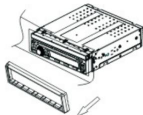
3 Dévissez l'écrou de vis M5 à l'arrière de l'appareil et retirez l'appareil.
