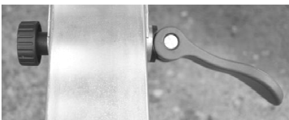
Position conforme - Replier le levier sur le timon. Rabattre en exerçant une pression ferme.
