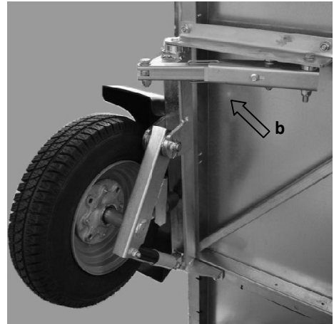
Position du bras (b) et de la roue avant roulage
