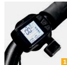
Display LCD per regolazione velocità e funzione clacson.
