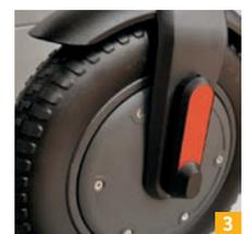
3 Freno elettrico anteriore e ruote tubeless.
