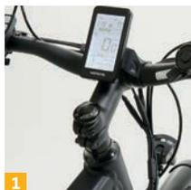
Schermo LCD per gestione e controllo parametri
