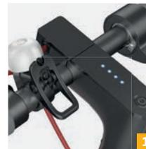
Monitoraggio livello di carica tramite LED integrati a manubrio.
