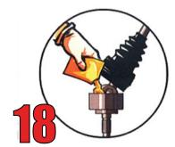
Remplir le bol de graisse. Ne pas mettre l'excédent de graisse dans le soufflet. Un surplus de graisse peut provoquer un balourd.
