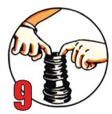
Malaxer énergiquement le soufflet pendant 20 sec. Mettre vos doigts à l'intérieur du petit diamètre pour l'écarter afin de préparer l'élasticité.
