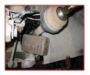
Surélever la transmission et le joint homocinétique avec une cale.
