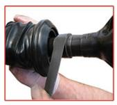
Remarque: pour les diamètres de transmissions inférieurs à 19 mm, grossir l'arbre avec une bandelette compensatrice. Repérer l'emplacement de serrage du soufflet sur l'arbre de transmission et retrousser le soufflet. Dégraisser l'emplacement et enrouler la totalité d'une
