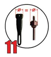
Choisir le cône dont le diamètre correspond au diamètre du cardan
