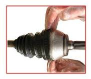
Rabattre la partie du soufflet retroussé sur le joint homocinétique. Tester la tenue du soufflet en articulant le joint homocinétique.
