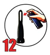
Lubrifier toutes les surfaces extérieures du cône articulé avec de l'huile, un rénovateur plastique (sans silicone) ou du savon liquide.
