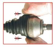
Ne pas tirer sur le soufflet. Risque d'extraction de la graisse et de blessure des doigts contre le joint homocinétique.
