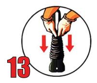
Mettre le soufflet sur le cône. Poser le cône sur le sol pour mettre correctement le soufflet en place. Positionner les 2 mains au-dessus du soufflet de façon à pouvoir pousser toute la matière. Ne pas tirer le soufflet.
