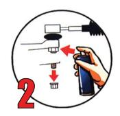
Utiliser du dégrippant pour dévisser l'écrou de la rotule
