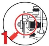
Déposer la roue et vérifier l'état général : - Soufflet de direction - Rotules
