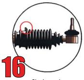
Si nécessaire, transpercer le téton pour enfiler la durite de mise à l'air libre
