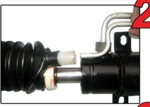
Approcher l'ensemble du dispositif sur la durite de mise à l'air libre.
