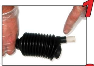
Enfiler le fit-tube dans le soufflet de façon à le faire ressortir par le téton
