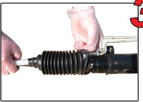
Mettre en place le fit-tube sur la durite.
