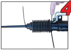
Retirer le fit-tube en maintenant le téton sur la durite.
