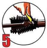
Faire glisser l'ancien joint Eventuellement le découper à l'aide d'une pince ou d'un cutter à lame rétractable
