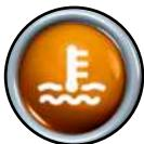
= Nível de líquido de refrigeração insuficiente
