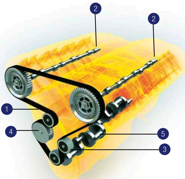
**A correia de distribuição é uma peça extremamente solicitada, cuja rutura provoca imediatamente a destruição de numerosas peças do motor como as válvulas. A sua substituição faz parte da manutenção normal do veículo.**
