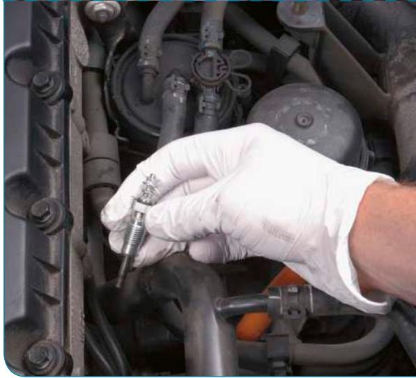
Existem dois tipos de velas, segundo as motorizações: as velas de ignição para os veículos a gasolina e as velas incandescência de pré-aquecimento para veículos a diesel.
