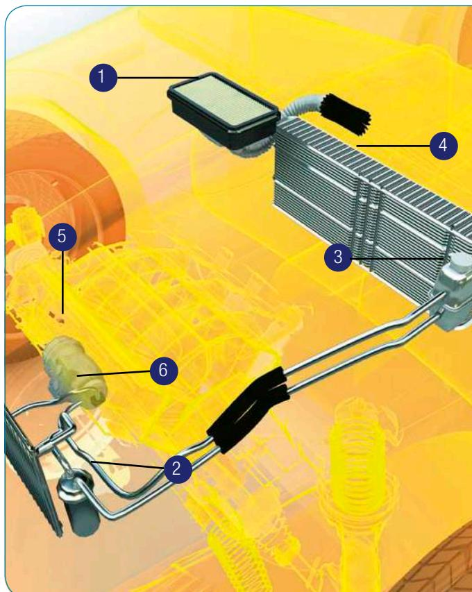
A climatização de uma viatura funciona do mesmo modo que um frigorífico em casa: ela transforma ar quente proveniente do exterior em ar frio graças a um fluido refrigerante (R134A) que circula em diferentes órgãos. A diferença essencial é que ela utiliza tubos flexíveis por causa das vibrações - estes favorecem as fugas.
