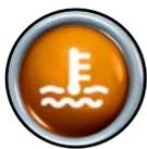
= Nível de líquido de refrigeração insuficiente
