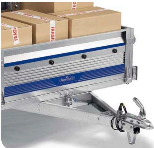
Graças ao sistema de travagem por inércia, o reboque travado alivia o veículo do peso do reboque a travar.
