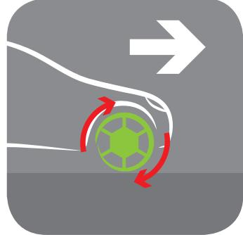
Les chaînes doivent être installées sur les roues motrices du véhicule.
