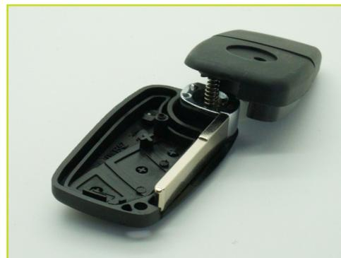
Positionnez maintenant la partie de la «coque arrière» en veillant à ce que l'ergot extérieur du ressort soit sur son point d'ancrage.
