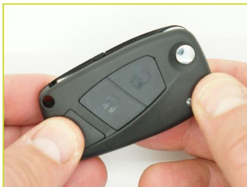
Aplatissez les 2 parties pour que la coque se referme et remettez les vis si nécessaire.
