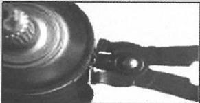
6. Avant de serrer le petit collier, équilibrez la pression de l'air en insérant un objet non-tranchant entre le soufflet et l'arbre
